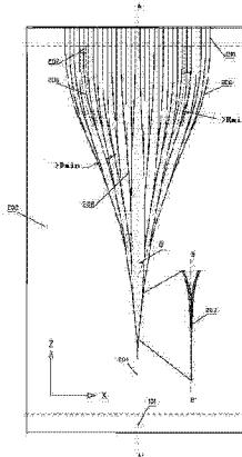
1. 一种紧密级联型  $1 \times N$  光功率分配器，包括一个输入波导和等距排列的 N 个输出波导，其特征在于：所述输入波导轴线与 N 个输出波导轴线平行，还包括分叉区，所述分叉区包括级联的  $N - 1$  个  $1 \times 2$  光功率分配器单元，级联数  $n = \log_2 N$ ，所述级联的  $N - 1$  个  $1 \times 2$  光功率分配器单元首级输入端连接所述输入波导、末级输出端由多段弧形波导和 / 或多段直波导分别连接 N 个输出波导，除第一级  $1 \times 2$  光功率分配器单元外，其余  $1 \times 2$  光功率分配器单元对称轴与所述输入波导轴线相交，所述  $N - 1$  个  $1 \times 2$  光功率分配器单元之间由单段弧形波导连接。
